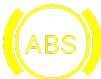
4. Es handelt sich um ein technisches System zur Verbesserung der Fahrsicherheit. Wenn man stark bremst, kann man die Räder blockieren ohne einen großen Bremsdruck.
